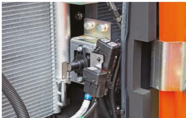
Grâce à l'interrupteur de déconnexion des batteries, les entretiens peuvent être effectués en toute sécurité.
