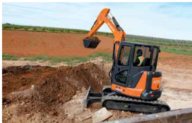
Grâce à son rayon de rotation arrière court, la ZX48U-6 convient parfaitement aux travaux dans les espaces réduits.
