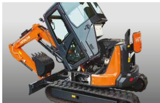
Le plancher inclinable garantit un accès facile au moteur et à la soupape de commande pour un entretien rapide.
