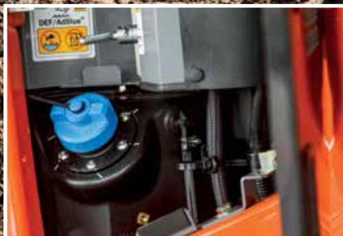
L'urée est injectée dans les gaz d'échappement pour réduire les émissions.
