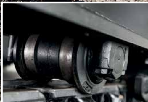
Le matériau renforcé utilisé dans la fabrication des galets améliore la résistance à l'usure.
