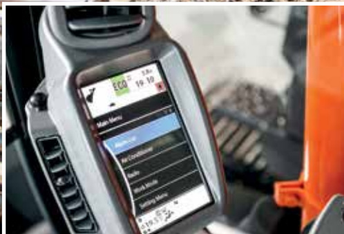
L'écran LCD affiche le statut et les paramètres de la machine.
