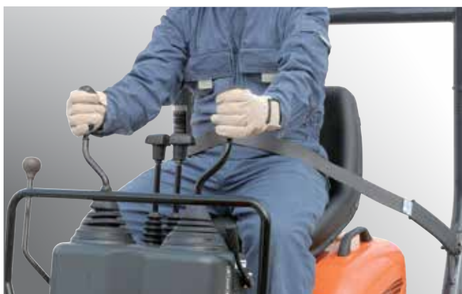
Les leviers hydrauliques de commande pilote garantissent le fonctionnement régulier de la machine.
